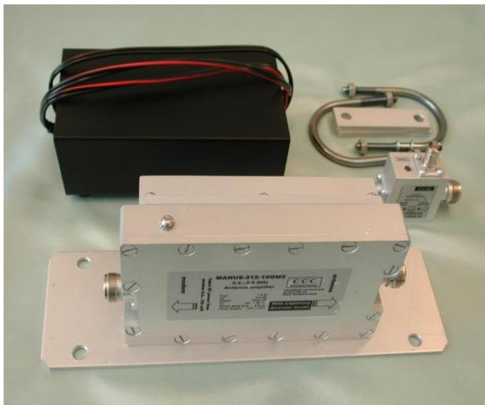
Предназначен для работы совместно с радиомодемами стандарта IEEE 802.11b/g в полудуплексном режиме. Усилитель обеспечивает компенсацию потерь в кабеле при приёме и передаче сигнала, увеличение дальности связи и повышение её качества. Имеет в своём составе встроенный гроозащитник и полосовой фильтр, обеспечивающий подавление внеполосных помех. Может изготавливаться с заданным усилением по требованию заказчика
