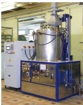
Печь предназначена для термической обработки изделий в среде водорода и азота при температурах до 1300 °С
