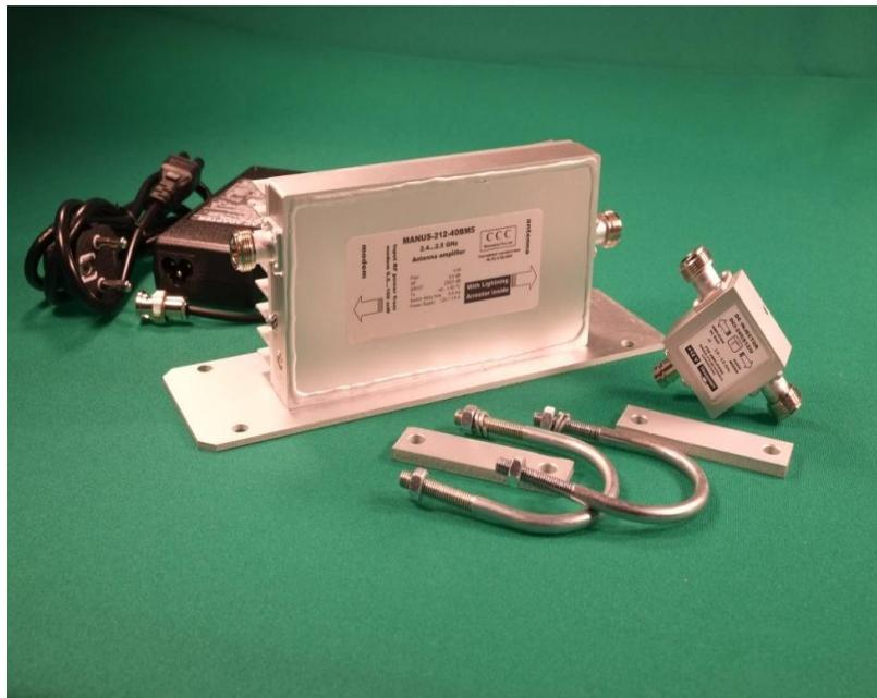
Предназначен для работы совместно с радиомодемами стандарта IEEE 802.11b в полудуплексном режиме. Усилитель обеспечивает компенсацию потерь в кабеле при приёме и передаче сигнала, увеличение дальности связи и повышение её качества. Имеет в своём составе встроенный грозозащитник и полосовой фильтр, обеспечивающий подавление внеполосных помех. Может изготавливаться с заданным усилением по требованию заказчика.
