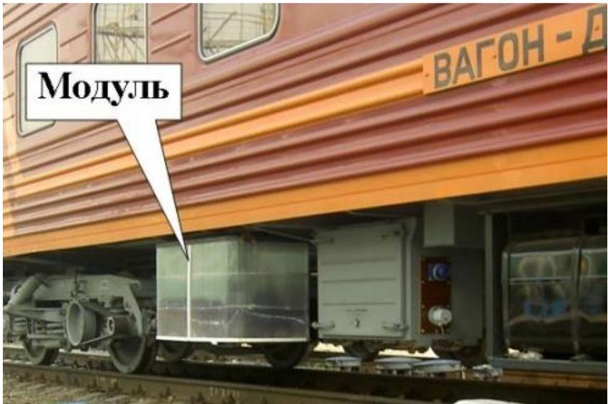
Устанавливается на вагоне-дефектоскопе железнодорожного пути и подключается к внутренней системе сбора и обработки информации вагона или размещается на ином подвижном объекте.
