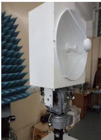
Автоматизированная система раннего предупреждения возникновения пожаров (АСПП) устанавливается на мачте высотой 80...100 метров. Работает в трёх диапазонах частот: оптическом, инфракрасном и миллиметровом.
