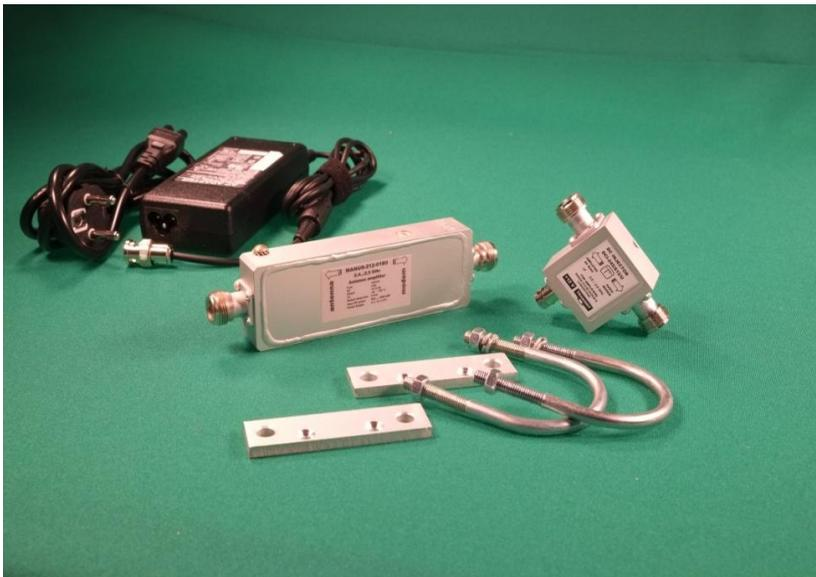
Предназначен для работы совместно с радиомодемами стандарта IEEE 802.11b в полудуплексном режиме. Усилитель обеспечивает компенсацию потерь в кабеле при приёме и передаче сигнала, увеличение дальности связи и повышение её качества. Имеет в своём составе встроенный грозозащитник и полосовой фильтр, обеспечивающий подавление внеполосных помех.
