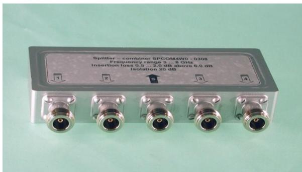
Предназначен для равного деления СВЧ мощности на четыре канала. Применяется при измерениях параметров СВЧ устройств, настройке и ремонте СВЧ аппаратуры и в приёмопередающих трактах систем связи.
