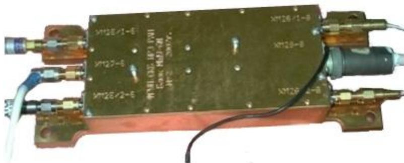
Малозошумящий усилитель (МШУ) предназначен для усиления сигнала с антенного облучателя радиометра.
