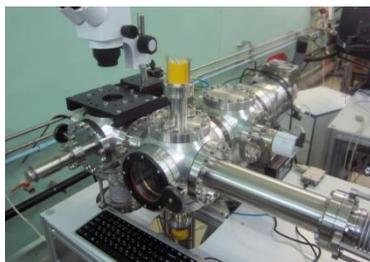
Предназначена для измерения параметров микроканальных пластин (МКП) в среде высокого вакуума.
