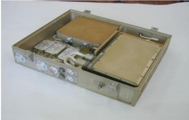
Предназначен для определения влажности почв и биомассы растительности, солёности морей при дистанционном зондировании Земли из космоса.
