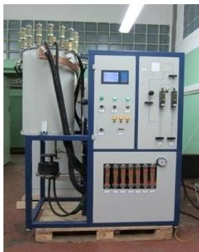
Предназначена для термической обработки изделий в среде водорода и азота при температурах до 2100 °С.
