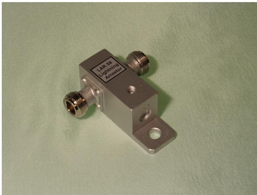
Предназначен для защиты входных сигнальных радиочастотных фидеров и приёмопередающих устройств от атмосферных разрядов. Представляет собой четвертьволновый короткозамыкатель.
