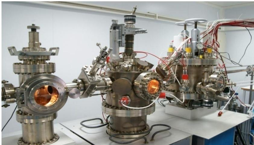
Предназначена для осуществления технологических процессов активации фотокатодных узлов и финишной сборки ЭОП поколения  $3^+$  способом переноса в среде сверхвысокого вакуума.
