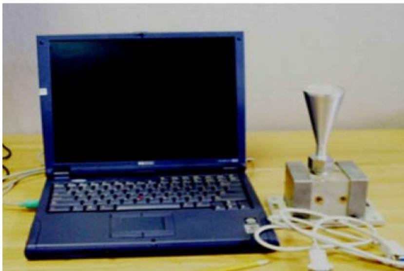
Предназначена для бесконтактного, дистанционного обнаружения в движущихся деталях и частях механизмов изменений геометрических параметров (загибов, забоин, износа, выработки и т.п.), а также параметров движения (частоты вращения, перемещения, вибраций и биений отдельных элементов и деталей конструкции) методом радиолокационного зондирования. Система легко адаптируется по требованию заказчика для диагностики при смене объекта или параметра контроля.
