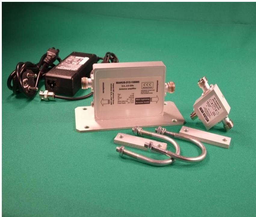
Предназначен для работы совместно с радиомодемами стандарта IEEE 802.11b в полудуплексном режиме. Усилитель обеспечивает компенсацию потерь в кабеле при приёме и передаче сигнала, увеличение дальности связи и повышение её качества. Имеет в своём составе встроенный грозозащитник и полосовой фильтр, обеспечивающий подавление внеполосных помех. Может изготавливаться с заданным усилением по требованию заказчика.
