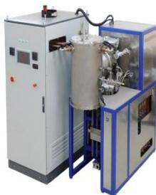
Предназначена для проведения термических процессов в вакууме при температурах до 2500 °С. Печь элеваторного типа – загрузка осуществляется снизу при помощи системы линейного перемещения.
