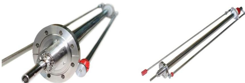
Изготавливаются линейные магнитные манипуляторы, обеспечивающие ввод поступательного и вращательного движения в вакуум. Линейное перемещение и вращение штока манипулятора осуществляется с помощью наружного постоянного магнита.
