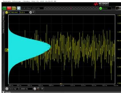
Рис. 4. Пример временной реализации генерируемого шумового сигнала и функция распределения его мгновенных значений
